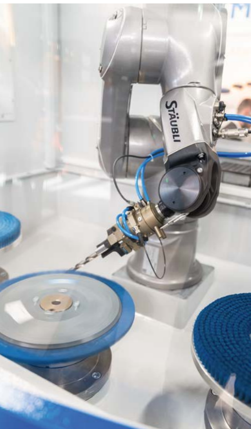
BS Robo: der Roboter führt die Werkstücke mit höchster Präzision an die Bürstwerkzeuge.
