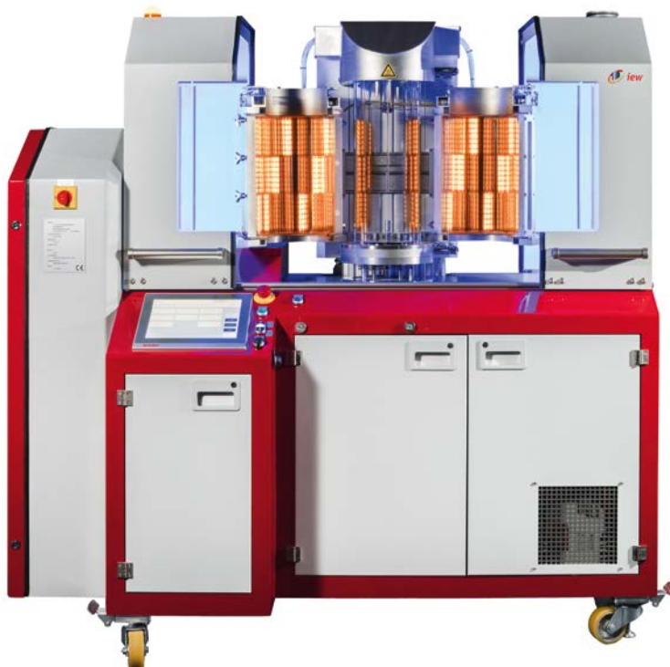
Vakuumlötanlage VVB200 mit patentierter 3-Zonen-Temperaturregelung
