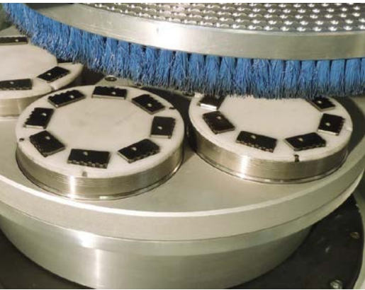
Mit der Gerber Bürst-Poliertechnologie werden Schneidplatten exakt verrundet und poliert.
