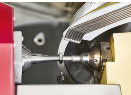
Die neue keramische Diamantschleifscheibe 6CVZ D93 eignet sich besonders zum effizienten Schleifen von Wendeschneidplatten.
