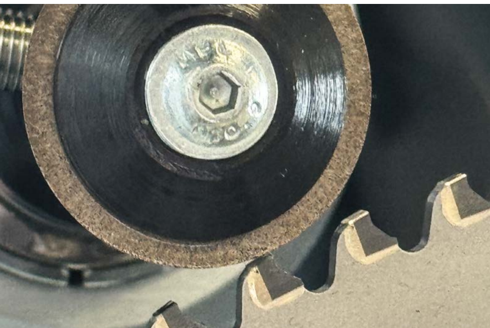
TWIN 860: Automatisches Einschleifen von Spanteilerrillen
